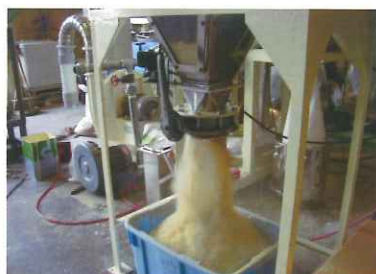
パルセーターランスを作動させ、 原料を排出している。
