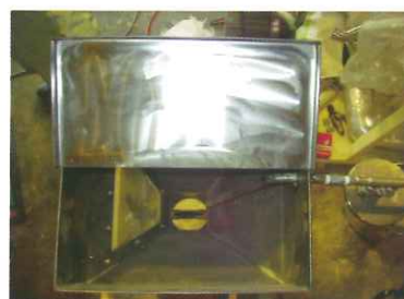
空になったタンク内部 右パルセーターヘッド タンク内部にパイプアクチベータ。
