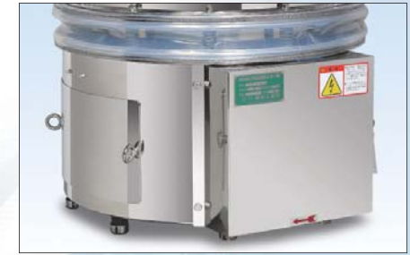
●モーターカバー モーターベース部への粉及び水の入りにくい構造になっています。
