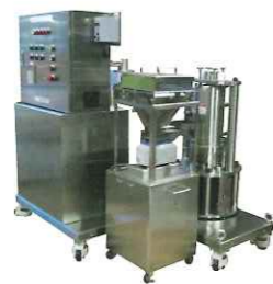
新規開発した気流粉砕ユニット SPM-R200DU型
