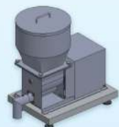
減算パッチ計量 引き算の秤量方式
