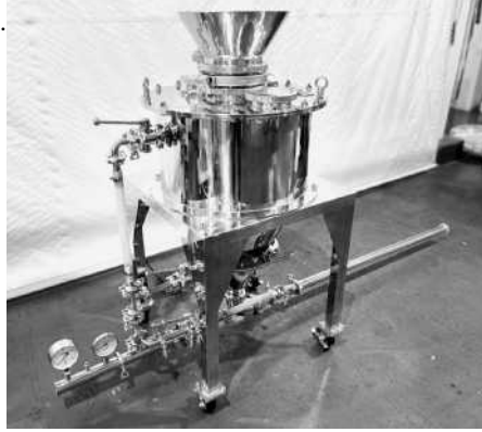
ブロワーで粉粒体を高濃度圧送する空気輸送機「デュアルローダー」
